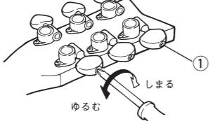
糸巻の回転トルクは、下図のトルク調整ネジ①で調節します。
