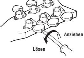
Die Stimmwirbel sind mit einem Federmechanismus ausgestattet, der sie automatisch gespannt hält und Spiel beseitigt. Der Wirbel-Drehwiderstand, d.h. die zum Drehen des Wirbels erforderliche Kraft, kann jedoch eingestellt werden. Jeder einzelne Wirbel verfügt über eine Einstellschraube, wie in der Abbildung dargestellt.
