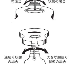
ヤマハギターは、すべて出荷前に調整をしてからお届けしていますが、環境の変化等によりリックの状態が変化する場合があります。ご使用の前に確認・調整なさる万全です。トラスロッドのナットを回して、ネックの反りを調整します。
