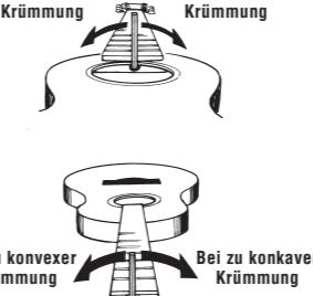
Die Halskrümmung sollte leicht konkav (nach innen gewölbt) sein. Drehen der Mutter im Uhrzeigersinn bewirkt mehr Spannung zum Korrigieren einer konvexen (nach außen gewölbten) Krümmung. Führen Sie diese Einstellung nach und nach in kleinen Schritten durch. Warten Sie nach jedem Schritt fünf bis zehn Minuten, bis sich die Spannung ausgeglichen hat, und kontrollieren Sie die Krümmung nach jeder halben (1/2) Umdrehung der Halsspannstabmutter.
