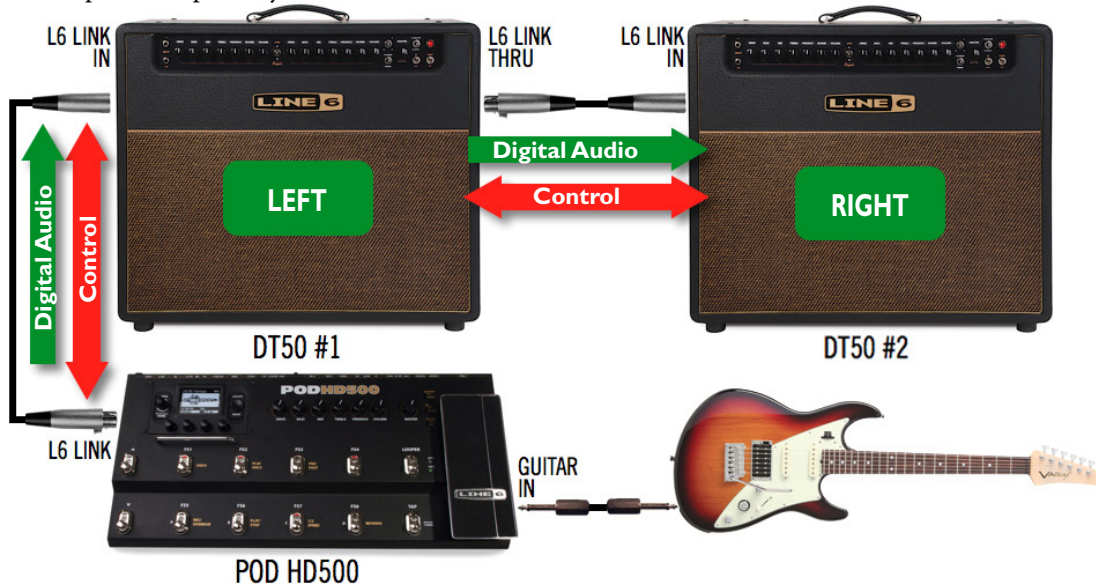
Настройка двух Усилителей DT в Стерео
