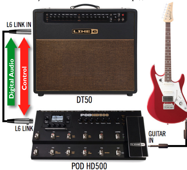
POD HD500, подключенный к DT50 посредством L6 LINK
