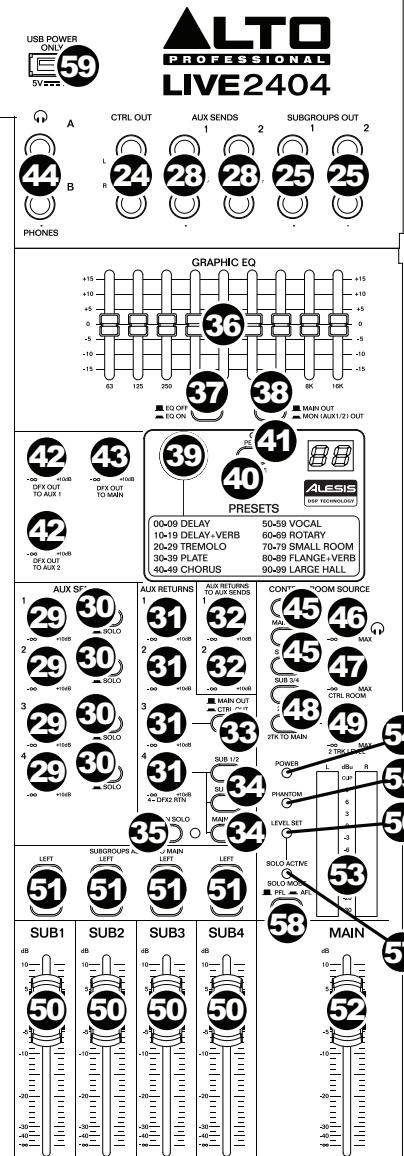
32. **Aux Returns an Aux Sends:** Benutzen Sie diese Regler, um den Pegel des Signals einzustellen, das vom entsprechenden Aux Return an den Aux Send-Bus mit der gleichen Nummer gesendet wird. Dies ist hilfreich, wenn Sie kaskadierende Mixer verwenden (wenn Sie z. B. die Aux Sends des Submixers an die Aux Returns dieses Mixers senden, damit der Control Room Mix des Submixers an die Untergruppen dieses Mixers und dann an seinen Control Room Mix geschickt werden kann).
