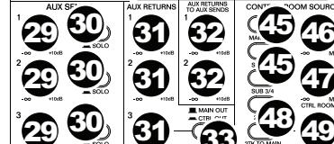
29. **Perillas de envío auxiliar:** Utilice estas perillas para controlar el nivel general de la señal enviada a las salidas auxiliares. (Utilice las perillas **Aux 1 a 4** en cada canal para controlar la señal enviada aquí desde cada canal).
