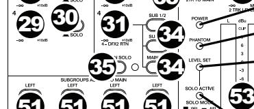
30. **Solo de envíos auxiliares:** Pulse estos botones para realizar un solo en ese canal en las **salidas para auriculares**.
